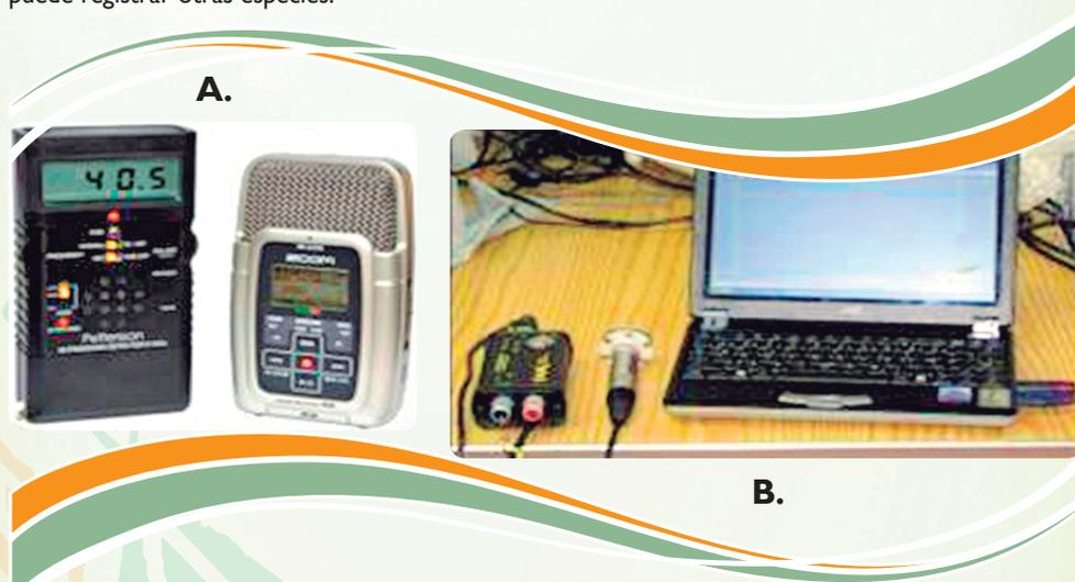
**Figura 4.** a) Detector Petterson D240X y grabadora digital Zoom H2, b) Micrófono externo de Avisoft.
